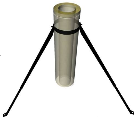
屋根上取付け支柱 (920)
